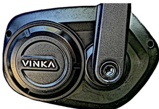
Bilde 4: Monter tilbake venstre deksel foran motoren
