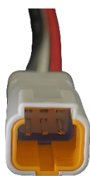
Fig. 1: Kontakt (3-pin) på kompatibel hastighetssensor
