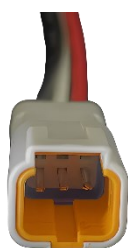
Fig. 1: Kontakt (3-pin) på kompatibel hastighetssensor
