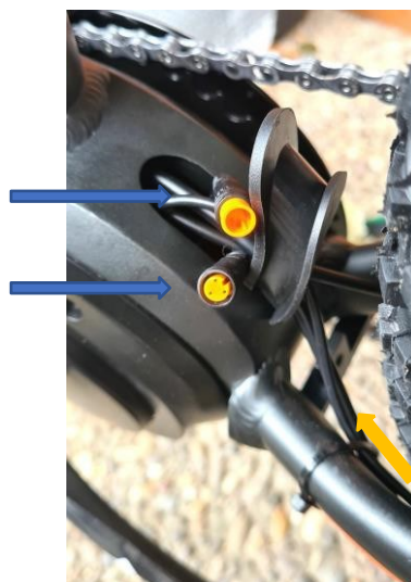
Fig. 3 Demontering av eksisterende hastighetssensor
