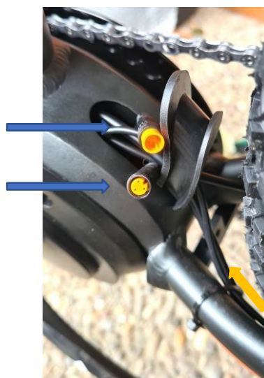
Fig. 4 Demontering av eksisterende hastighetssensor
