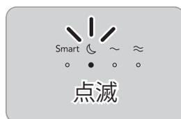
3. 運転モード切換ボタンを押して、お好みのセンサー感度に調整します。運転モード表示ランプが点滅し、現在選択しているセンサー感度を表示します。
