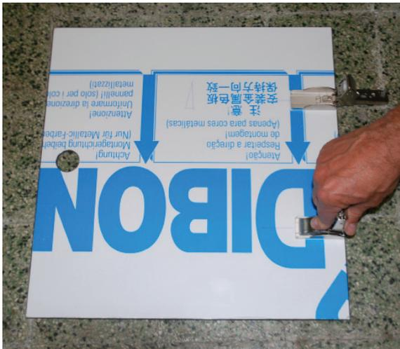
Die Bänder an der Tür befestigen (Bänder in zugeklappter Position)
