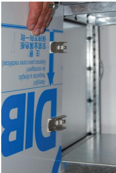
Flügeltür an der zu montierenden Stelle ans Regal halten um die Position der Stabilisationsplatten herauszufinden.
