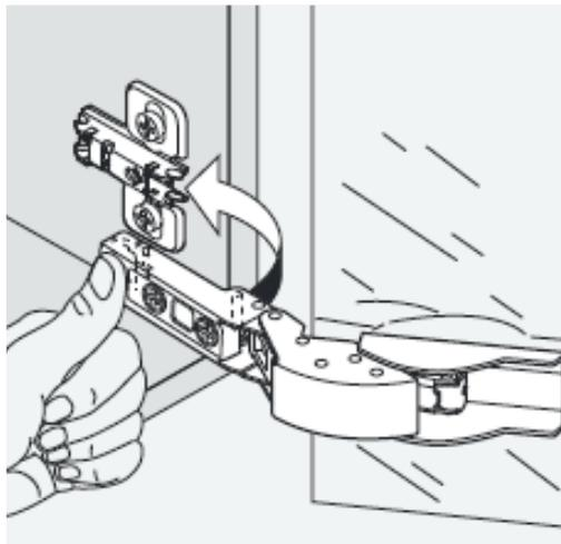
Das Band in offenem Zustand bei der Stabilisationsplatte einhängen.
