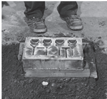
3. 木型を抜き取ることにより鑄型ができる
