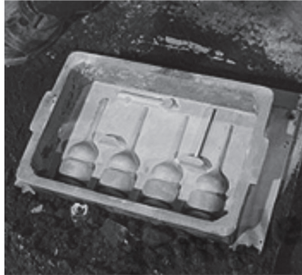
1. 製品と同じ型上の木型を作り、金杵を乗せて砂が逃げないようにする
