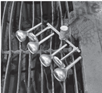
5. 金属が固まったら型から製品を取り出し、表面についた砂を取り除く
