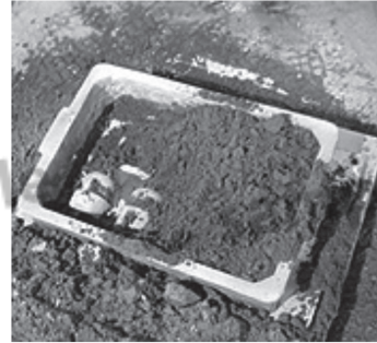
2. 木型の周りに砂を敷き詰め、押し固めていく
