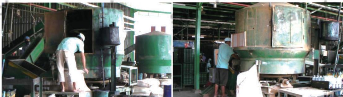
2. ダブルコイル状に打ち抜く：左が旧来の中村式、右側が生産効率 1.5 倍のコイルマスター式
