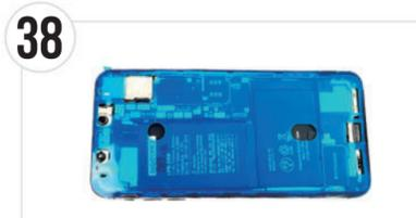
● 防水テープの貼り付ける向きや位置を合わせ(※上図参照)本体の上に仮置きします。
