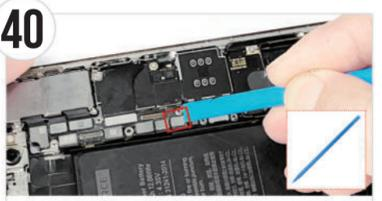
● ヘラ(棒状)の平面側を使用して、図の赤枠部分にあるバッテリーコネクタを取り外します。コネクタ部分や基板を損傷させないようにご注意ください。
