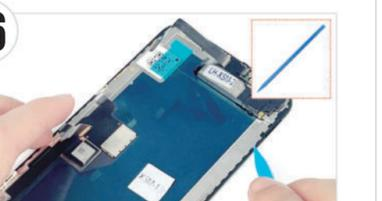
● 液晶画面の裏面周囲に残っている防水テープも、同様に取り除いてください。ケーブルやコネクタ部分等を損傷させないようにご注意ください。
