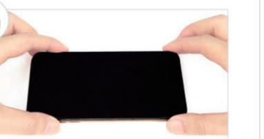
● 液晶画面をベットボトル(常温)から取り外し、本体に合わせて軽く押し込みます。
