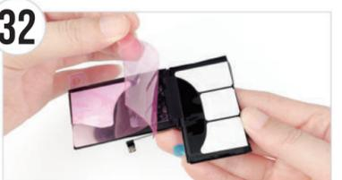
● コネクタ部分の形状を確認(または整えた)後、ピンクのフィルムを剥がします。
