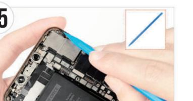
● 図のようにヘラ(棒状)の先端側を使用して、本体フレーム周囲に残っている防水テープを取り除きます。ヘラ(棒状)の先端でバッテリーや内部のパーツを突き刺したり、傷ついたりしないようご注意ください。
