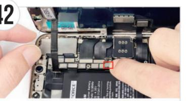
● 図の赤枠部分にバッテリーコネクタを慎重に取り付けます。正確に取り付けられると「カチッ」とした音と感触があります。コネクタ部分や基板、ケーブル等を損傷させないようにご注意ください。
