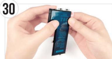
● 両面テープの端の黒い部分は、図のようにバッテリーに沿って折り曲げ、貼り付けます。残りの3箇所も同様貼り付けてください。
