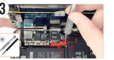
● ピンセット(絶縁)を使用して保護プレート(C)を仮置きし、Y字ドライバでプレートのネジ(7~9)を取り付け固定します。ネジの取り付け位置を間違えないようご注意ください。
