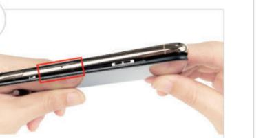
● 図の赤枠部分(液晶画面と本体の間)にケーブルが挟まっていたかを確認してから、液晶画面をはめてください。ケーブルを挟み込むと断線により液晶画面の機能に不具合が生じる恐れがございます。ご注意ください。
