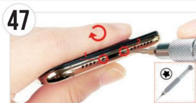
● ドライバーの先端を星形ドライバーに交換し、図の赤丸2カ所(1・2)にネジを取り付けると終了です。※バッテリー交換終了後は、手順01で行った「画面表示の明るさの設定(明るさ/自動ロック)を元の状態に戻してください。
