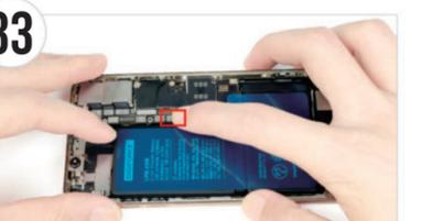
● バッテリーを本体に置く(接着)前に、図の赤枠部分にあるバッテリーコネクタを取り付けてください。コネクタを取り付ける前にバッテリーを接着すると、コネクタが接合部分に追加加わる場合がありますのでご注意ください。コネクタが正常に取り付けられると「カチッ」とした音と感触があります。次に、バッテリーを置き、軽く押し込んで固定してください。
