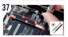
ピンセット(絶縁)を使用して「ΔIのプレートを置きます V字 ドライバーを使用して、プレートのネジ (3~7) を取り付けます Use tweezers to place the metal plate (A), then use the Y-type screwdriver to screw in the screws (found on the magnetic pad
