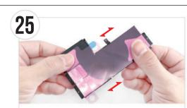
● バッテリー用両面テープを上下に複数回押さえて、しっかりと 貼り付けます。テープの端にある黒い部分は折り曲げて バッテリーに貼り付けます。
