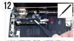
● ピンセット(絶縁)を使い、図のプレートを取り外しマグネットシート の「A」に置きます。
