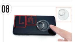
■ 図の向きになるよう、本体を半回転させてください。吸盤の突起部分を引っ張って 吸盤を取り外します。図の赤枠部分2か所の内部にケーブルがあるため、破損 させないよう注意をしながら液晶画面の手前側を慎重に開いてください。 Pull on the small tab on the suction cup to remove it from the phone.
