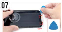
図の2か所の内側に留め金があるので、少し左側(矢印の方向)に押しながら ピック(厚手)をスライドして液晶画面を浮かせます。内部のケーブルが破損 する恐れがありますので、まだ、液晶画面を開かないようご注意ください。
