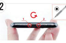
● 図の2か所のネジを星形ドライバーで外し、マグネットシート の該当する番号へ置きます。
