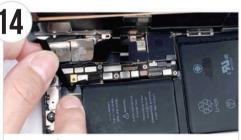
● 図のケーブルは粘着剤で引っ付いているので、破損させない よう手で慎重に引き離してください。
