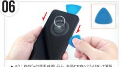
もう1枚のピック(厚手)を差し込み、矢印の方向へスライドをして液晶 画面を浮かせていきます。両側行ってください。SIMトレイ側の内部に はケーブルがあるので、破損させないよう慎重にスライドしてください。
