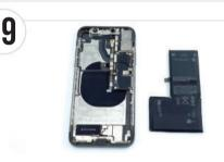
3本のバッテリー用両面テープが全て抜き取れたら、 バッテリーを本体から取り外します。
