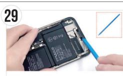
図のようにへラ(棒状)の平面側を使用して、本体 フレームの端に残っている防水テープを取り除きます。
