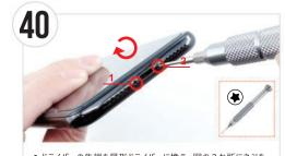
● ドライバーの先端を星形ドライバーに換え、図の2か所にネジを 取り付ければ完成です。
