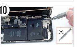
● ドライバーの先端をY字ドライバーに換え、図の部分に 2 秒ほど置き、磁力を帯びさせてください。
