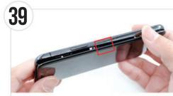
● 図の赤枠の位置にあるケーブルが、液晶画面と本体の間に挟まっていないかを、必ず確認して ください。ケーブルを挟み込んでしまうと、ケーブルの損傷により液晶画面の機能(表示・タッチ等) に不具合が生じる恐れがあります。ケーブルが挟まりそうな場合は、ヘラ等でケーブルを本体内部 に軽く押し込みながら、液晶画面をはめてくださし
