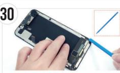
● 液晶画面裏側の端に残っている防水テープも、図のように へう (棒状) の平面側を使用して取り除きます。
