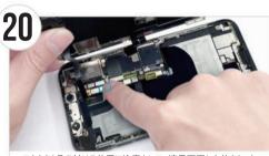
■ コネクタを取り付ける位置に注意をして、液晶画面と本体をセット します。図の青枠→緑枠→黄枠の順に、コネクタを慎重に取り付け ます。正確にはめられた場合、「カチッ」とした音と感触があります。 Use your hands to attach the screen cables in the order of blue→green yellow. When you attach the cable, you should hear a "click" sound indicating that the cable has been successfully attached.
