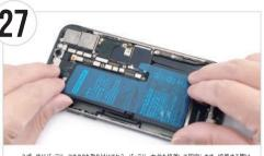
必ず、先にバッテリーコネクタを取り付けてから、バッテリー本体を接着して固定します。接着する際は、 気持ちコネクタ側に寄せるようにしてください、おしも先に、バッテリー本体を採着してからコネクタを取り 付けてしまうと、コネクタ部分が届かず接続出来なくなる場合がありますので、ご注音ください。 Use your fingers to attach the battery cable, when you attach the cable, you
