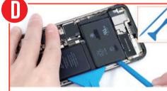
へラ(幅広)だけで引き離せない場合は、図のようにヘラ(棒状)も使用して、少しずつ持ち 上げて、バッテリーを取り外します。iPhone本体に破損させないよう注意してください。また ッテリーを強引に持ち上げ変形させたり、傷をつけたりすると、発煙・発火の恐れがございます。
