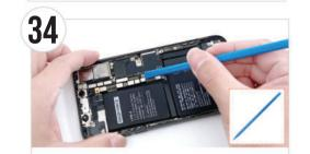
● 液晶画面のコネクタを取り付ける際のショートを防ぐため、図 のようにヘラ(棒状)の平面側を使用し、バッテリーコネクタ
