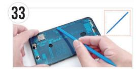
・ 防水テープの周囲をヘラ (棒状)の平面側で押し、本体に しっかりと貼り付けてから保護シートを剥がします。
