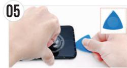
隙間を広げるため、吸盤を手で引き上げながら、充電差し込み□側にできた。 隙間にピック(蓮手)を差し込み固定します。粘着が強力なので吸盤で引き 上げ過ぎると、内部のケーブルが破損する恐れがあります。ご注意ください。 While pulling the suction cup by hand, insert the thin paddle into the gap between the screen and the phone, inserting in the lower left corner of the phone. Due to the waterproof glue the screen is firmly attached so
