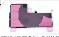
◆ 交換用バッテリーの裏面(印字の無い面)にバッテリー用両面テープを 貼ります。バッテリー用両面テープの位置は、図のようにテープの端にある 黒い部分がバッテリーからはみ出るようにしてください。
