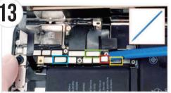
◆ △ラ(棒状)の平面側を使用し、図の赤枠部分のバッテリーコネクタを恒重に 取り外します。次に、図の黄枠→緑枠→青枠の順にコネクタを慎重に取り 外します。取り外す際は、コネクタ部分を破損させないようご注意ください。
