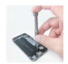
ネジに対して垂直に力を 加えながら回してください。 Reference pose for screwdriver use 螺丝刀使用参考姿势
