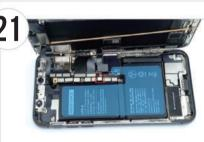
交換用バッテリーが正常に作動するかを確認するため、1度、交換 用バッテリーを本体に仮置きをし、バッテリーコネクタを慎重に取り付け ます。正確にはめられた場合、「カチッ」とした音と感触があります。
