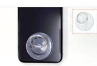
図のように、液晶画面の下部中央の位置に吸盤を貼り付けます。本体を 反対側の手でしっかりと持ち、慎重に引き上げ、液晶画面と本体の間に 2mmぐらいの隙間をつくります。
