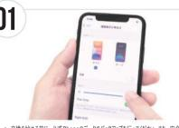
● 交換を始める前に、必ずiPhoneのデータのバックアップを行ってください。また、安全に交換を 行うため、画面の「設定」→「画面表示と明るさ」を選び、「明るさ→最大」・「自動ロック→なし」 に設定し、電源がOFF(バッテリー残量0%)になってから交換を始めてください。
