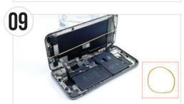
● 液晶画面を開いたら、中身の入った500mlのペットボトルと液晶 画面を輪ゴムで図のように固定します。液晶画面を90度以上 開くと、ケーブルを破損させる恐れがあるのでご注意ください。
