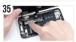
● 図の青枠→緑枠→黄枠の順に、液晶画面のコネクタを慎重に取り付け ます。正確にはめられた場合は「カチッ」とした音と感触があります。また、 手順14で接着を外したケーブルの固定も忘れずに行ってください。
