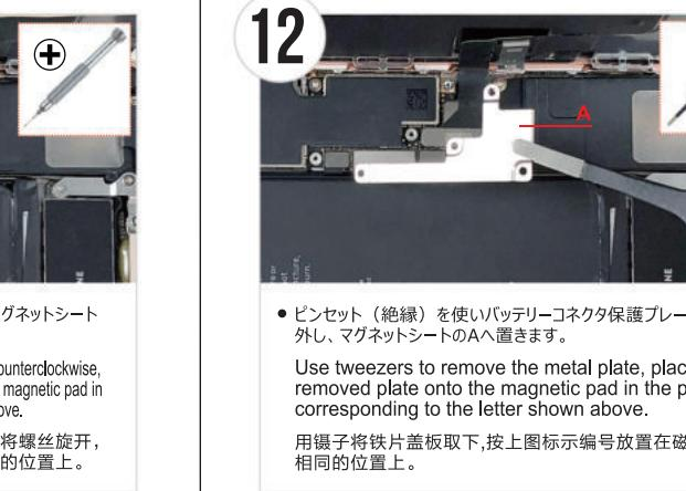
● ピンセット（絶縁）を使いバッテリーコネクタ保護プレートを取り外し、マグネットシートのAへ置きます。
