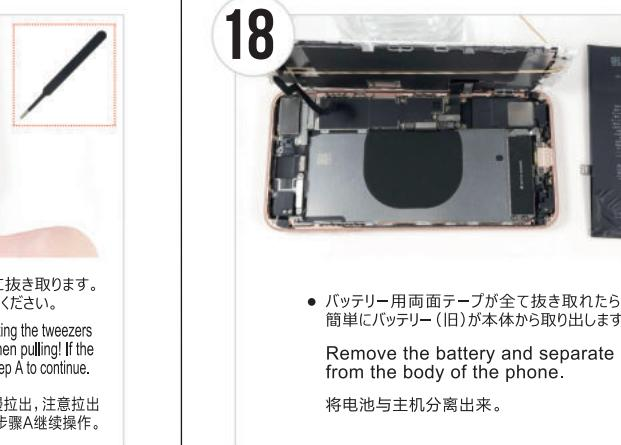
● バッテリー用両面テープが全て抜き取れたら、簡単にバッテリー（旧）が本体から取り出します。
