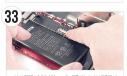
● コネクタ接続前にバッテリーをiPhone本体へ接着すると、コネクタの接続がうまく 合わない場合があります。バッテリー用両面テープの残りのピンクのシートを剥がし、 先にパッテリーのコネクタを接続してからパッテリーを本体に取り付けます。 Use your fingers to initially attach the battery cable, When the battery cable is attached, a "dick" sound is heard, indicating it has been successfully attached ther
