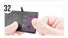
● バッテリー用両面テープの黒い部分をバッテリーに巻き付け るように貼り付けます。
