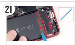
● バッテリーの外装が破れないように注意してください。へラ (棒状)等を 使い、バッテリー用両面テープの里い部分をバッテリーから剥がします。
