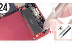
た右を一度仮締めしてバランフをとってから木締めしてください、ピンセット(編録)とブラフドラ イバーを使用し、(18・19・20)番で取り外したバイブレーターを逆の手順で取り付けます。 Use tweezers to place the metal part (C) and use the Phillips screwdriver to screw in the screws (found on the magnetic pad in the position corresponding to the number shown above). Use your fingers to attach the cable. When the cable is attached, a "click"
