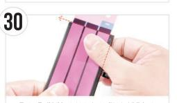
図のように黒い部分がバッテリーからはみ出るように貼ります。交換用バッテリー (新)の裏面(印字の無い面)にバッテリー用両面テープを張り付けます。
