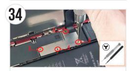
● 一度仮締めしてバランスをとってから本締めしてください。バッテリーコネクタ保 護プレートをピンセットとソ字ドライバーを使用し該当番号通り取り付けます。
