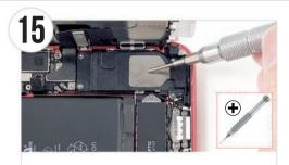
● ドライバーの先端をプラスドライバーに換え、2秒ほど図の部分 にあて磁力を帯びさせてください。
