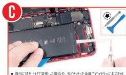
けると発煙・発火の恐れがございます。少しづつ力を加えて持ち上げ、隙間より 両面テープをドライバーの先端へ巻き付けて引っ張り、伸ばして抜き取ります。 Use the wide prying tool to lift up the battery enough to see the broken battery adhesive Jse the star shaped screwdriver to pull the broken battery adhesive, rotating it out slowly Take care when using the screwdriver, do not use excessive force to puncture the battery. 用宽型撬棒将电池撬起可以看见断裂的电池胶,再用星型螺丝刀刀头将断裂 电池胶粘住并旋转向外缓慢拉出。注意螺丝刀头,不要用力过大戳破电池!
