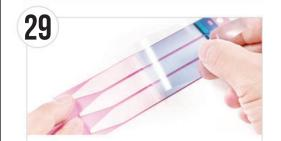
バッテリー用両面テープの青いフィルムを図のように下側から剥がします。
