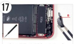
● ピンセット (絶縁) を使い保護プレートを取り外し、マグネ ットシートのBへ置きます。
