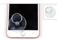
● 図のように液晶画面のホームボタンに対して3mm~10mmの位置の左寄 りに吸盤を貼り付け、本体を反対側の手でしっかり持ち、慎重に引き上げま す。目安はガラス面と本体の間に2mmぐらいの隙間を作ります。
