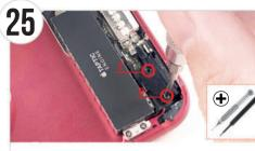
● ピンセット (絶縁) とプラスドライバーを使用し、(16・17) 番で取り外し た保護プレートを逆の手順で取り付けます。
