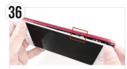
図のケーブルが液晶と本体の間に挟まると断線・液晶の破損となります。 ヘラ等で本体内部に軽く押し込みながら液晶パネルをはめてください
