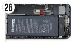
コネクタの折り曲げ角度を先ほど取り外したバッテリー(川)と同じ形状 に調整してください。一度バッテリーのコネクタを取り付け、位置決め (配線の角度調整)を行ってください。
