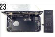
バッテリー田両面テープが全て抜き取れたら 簡単にバッテリー(旧)が木休から取り出せます
