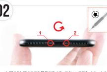
図の2か所のネジを星形ドライバーで外し、マグネットシートの 該当番号へ置きます。
