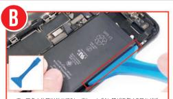
赤い四角の位置以外で行うと、ボリュームボタン等が損傷する恐れがこ ざいます。ヘラ(幅広)を図の赤い四角で囲った位置(バッテリーの左 下部)に入れ、テコの容量で少しずつ持ち上げます。 The area to insert the wide prving tool is highlighted in red. Do not insert
