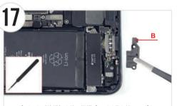
● ピンセット (絶縁) を使い保護プレートを取り外し、マグネ ットシートのBへ置きます。
