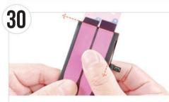
図のように黒い部分がバッテリーからはみ出るように貼ります。交換用バッテリー (新)の裏面(印字の無い面)にバッテリー用両面テープを張り付けます。
