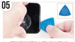
・ 充電差込口側にできた隙間にピック(薄型)を差し込み固定します。
