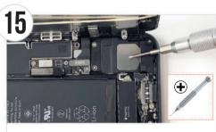
● ドライバーの先端をプラスドライバーに換え、2秒ほど図の部分 にあて磁力を帯びさせてください。
