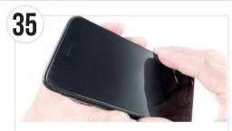
● 液晶パネル上部のツメを本体に引っ掛けて、上部よりゆっくりと 液晶パネルをはめてください
