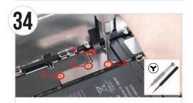
● 一度仮締めしてバランスをとってから本締めしてください。バッテリーコネクタ保 護プレートをピンセットとソ字ドライバーを使用し該当番号通り取り付けます。
