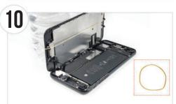
90度以上開くと液晶ケーブルを破損する一因となります。中身の入った500 ミリのペットボトル等に液晶画面を開いて輪ゴム等で固定します。
