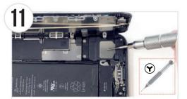
● ドライバーの先端をY字ドライバーに換え、2秒ほど図の部分 にあて磁力を帯びさせてください。
