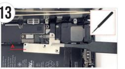
ピンセット(絶縁)を使いバッテリーコネクタ保護プレートを取り 外し、マグネットシートのAへ置きます。
