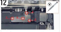
図のプレートのネジをY字ドライバーで外し、マグネットシートの 該当番号へ置きます。
