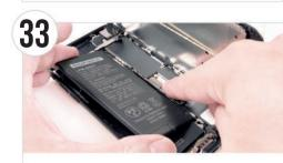
■ コネクタ接続前にバッテリーをiPhone本体へ接着すると、コネクタの接続がうまく 合わない場合があります。バッテリー用両面テーブの残りのピンクのシートを剥がし、 先にバッテリーのコネクタを接続してからバッテリーを本体に取り付けます。 Use your fingers to initially attach the battery cable, When the battery cable is
