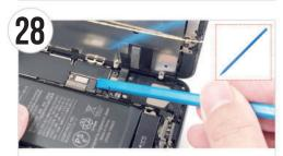
● バッテリーのコネクタをヘラ (棒状)の平面側を使い外します。
