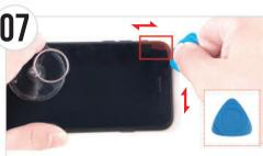
● 図の角の部分の接着が強いため、何度かゆっくりとへラを動 かして剥離してください。
