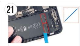
● バッテリーの外装が破れないように注意してください。へラ (棒状)等を 使い、バッテリー用両面テープの里い部分をバッテリーから剥がします。
