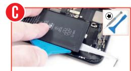
強引に持ち上げて変形した場合や、先のとがった金属でバッテリーにキズを付 けると発煙・発火の恐れがございます。少しづつ力を加えて持ち上げ、隙間より 両面テープをドライバーの先端へ巻き付けて引っ張り、伸ばして抜き取ります。 Use the wide prying tool to lift up the battery enough to see the broken battery adhesive Jse the star shaped screwdriver to pull the broken battery adhesive, rotating it out slowly Take care when using the screwdriver, do not use excessive force to puncture the battery. 用宽型撬棒将电池撬起可以看见断裂的电池胶,再用星型螺丝刀刀头将断裂
