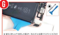
けると発煙・発火の恐れがございます。少しづつ力を加えて持ち上げ、隙間より 両面テープをドライバーの先端へ巻き付けて引っ張り、伸ばして抜き取ります。 Use the wide prying tool to lift up the battery enough to see the broken battery adhesive Use the star shaped screwdriver to pull the broken battery adhesive, rotating it out slowly. Take care when using the screwdriver, do not use excessive force to puncture the battery. 用宽型撬棒将电池撬起可以看见断裂的电池胶,再用星型螺丝刀刀头将断裂
