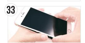
● 液晶パネル上部のツメを本体に引っ掛けて、上部よりゆっくりと 液晶パネルをはめてください。
