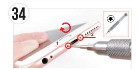
●(02) 番で取り外したネジ2か所を星形ドライバーで取り付けれ
