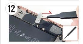
● ピンセット (絶縁) を使いバッテリーコネクタ保護プレートを取り 外し、マグネットシートのAへ置きます。
