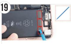
● バッテリーの外装が破れないように注意してください。へラ (棒状)等を 使い、バッテリー用両面テープの黒い部分をバッテリーから剥がします。
