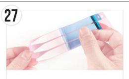
● バッテリー用両面テープの青いフィルムを図のように下側から剥がします
