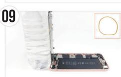
90度以上開くと液晶ケーブルを破損する一因となります。中身の入った500 ミリのペットボトル等に液晶画面を開いて輪ゴム等で固定します。
