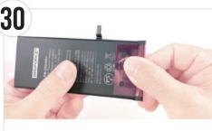
● バッテリー用両面テープの黒い部分をバッテリーに巻き付け るように貼り付けます。
