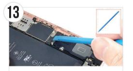
● バッテリーのコネクタをヘラ(棒状)の平面側を使い外します。
