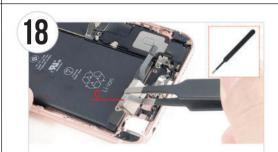
● ピンセット (絶縁) を使いバイブレーターを取り外し、マグネッ トシートのCへ置きます。
