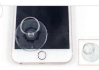
● 図のように液晶画面のホームボタンに対して3mm~10mmの位置の左寄 りに吸盤を貼り付け、本体を反対側の手でしっかり持ち、慎重に引き上げま す。目安はガラス面と本体の間に2mmぐらいの隙間を作ります。 Stick the suction cup to the screen, above and left of the
