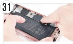
■ コネクタ接続前にバッテリーをiPhone本体へ接着すると、コネクタの接続がうまく 合わない場合があります。バッテリー用両面テープの残りのピンクのシートを剥がし、 先にバッテリーのコネクタを接続してからバッテリーを本体に取り付けます。 Use your fingers to initially attach the battery cable, When the battery cable is attached, a "dick" sound is heard, indicating it has been successfully attached.then place the battery in the battery slot. After placing it securely, press down gently. 用手指先扣好电池排线,扣电池排线时,听到"啪"的声音表示
