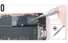
● ドライバーの先端をプラスドライバーに換え、2秒ほど図の部分 図のプレートのネジをプラスドライバーで外し、マグネットシート の該当番号へ置きます。
