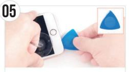
● 充電差込口側にできた隙間にピック(薄型)を差し込み
