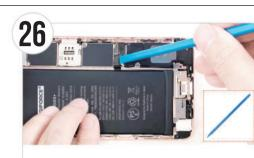
● バッテリーのコネクタをヘラ(棒状)の平面側を使い外します。
