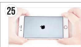
● 動作確認 (電源ON) を行ってください。動作確認後は必ず電源 をOFFにしてください。
