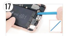
● 図のコネクタをヘラ (棒状)の平面側を使い外します。 Use the prying tool to pry the cable of the part.
