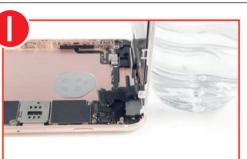
● 図のように液晶パネルを輪ゴムで固定します。高さなどを調整 しながら、図のように液晶画面のコネクタを本体に近づけます。
