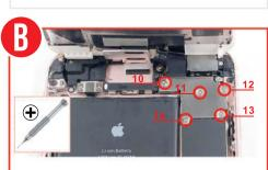
● プラスドライバーを使い、図の液晶コネクタ保護プレートのネジ5か所 を取り、それぞれマグネットシートの該当番号へ置きます。
