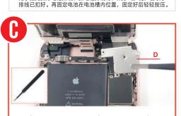
● ピンセットで液晶コネクタ保護プレートを取り外し、マグネッ トシートのDへ置きます。
