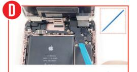
ヘラ(棒状)を使用し、液晶画面のコネクタを次の「F」の 図を参昭し、(赤→黄→青)の順番に外していきます。
