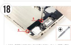
● 左右を一度仮締めしてバランスをとってから本締めしてください。ピンセット(絶縁)とプラス ドライバーを使用し、(13・14) 番で取り外したバイブレーターを逆の手順で取り付けます。
