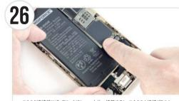
● コネクタ接続前にバッテリーをiPhone本体へ接着すると、コネクタの接続がうまく 合わない場合があります。バッテリー用両面テーブの残りのピンクのシートを剥がし、 先にバッテリーのコネクタを接続してからバッテリーを本体に取り付けます。
