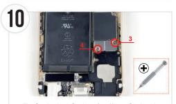
図のプレートのネジをプラスドライバーで外し、マグネットシート の該当番号へ置きます。
