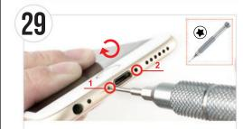
●(02) 番で取り外したネジ2か所を星形ドライバーで取り付けれ
