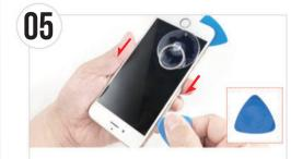
もう一枚のピック(厚手)を差し込んだままスライドさせ液 晶画面を浮かせていきます。両側に行ってください。 Use the thick paddle and drag it down the gap on each
