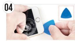
充電差込口側にできた隙間にピック(薄型)を差し込み 固定します
