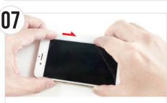
● 矢印の方向に液晶パネルを1mmほどスライドさせてください。
