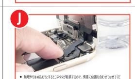
さい。液晶のコネクタを図「E」を参照し、(青→黄→橙→赤) の順番にはめ込みます。 Take care when reattaching the screen cables, to prevent the screen cables breaking. Use your finger to reattach the screen cables in order of colour from
