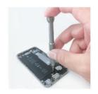
ネジに対して垂直に力を 加えながら回してください。 Reference pose for
