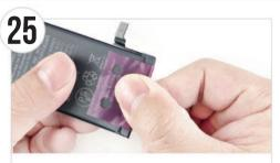
● バッテリー用両面テープの黒い部分をバッテリーに巻き付け るように貼り付けます。
