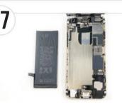
● バッテリー用両面テープが全て抜き取れたら 簡単にバッテリー(旧)が本体から取り出せます。
