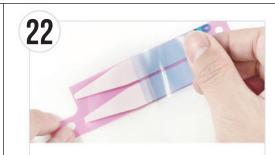
バッテリー用両面テープの青いフィルムを図のように下側から剥がします。
