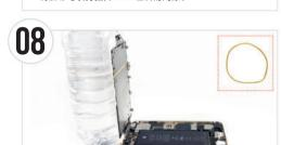
● 90度以上開くと液晶ケーブルを破損する一因となります。中身の入った500 ミリのペットボトル等に液晶画面を開いて輪ゴム等で固定します。
