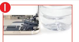
● 図のように液晶パネルを輪ゴムで固定します。高さなどを調整 しながら、図のように液晶画面のコネクタを本体に近づけます。
