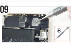
● ドライバーの先端をプラスドライバーに換え、2秒ほど図の部分 にあて磁力を帯びさせてください。
