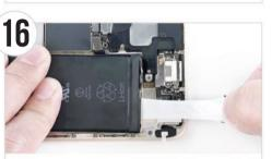
バッテリー用両面テープ(左側)の黒い部分を持ち、できるだけ角度を付けずに引き伸ばします。 同じように(右側)も行ってください。テープが途中で切れた場合は『裏面A』へお進みください。 Use your fingers to pull the battery adhesive away from the battery and towards the
