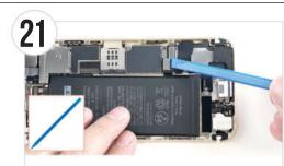
バッテリーのコネクタをヘラ(棒状)の平面側を使い外します。
