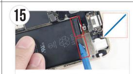
● バッテリーの外装が破れないように注意してください。へラ (棒状)等を 使い、バッテリー用両面テープの黒い部分をバッテリーから剥がします。
