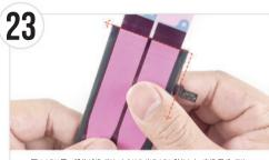
● 図のように黒い部分がバッテリーからはみ出るように貼ります。交換用バッテリー (新)の車面(印字の無い面) にパッテリー用面面テープを張り付けます。
