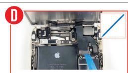
◆ へラ(棒状)を使用し、液晶画面のコネクタを次の「E」の 図を参照し、(赤→橙→黄→青)の順番に外していきます。
