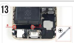
図の2か所のネジをプラスドライバーで外し、マグネットシートの該 当番号のところに置きます。
