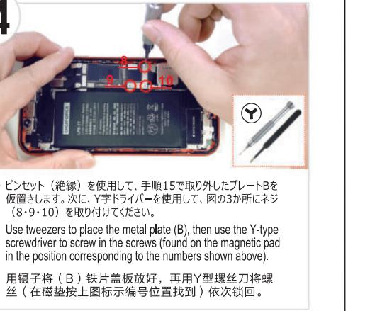
● ピンセット（絶縁）を使用して、手順15で取り外したフレートBを仮置します。次に、Y字ドライバーを使用して、図の3か所にネジ（8-9-10）を取り付けてください。
