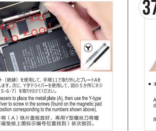
● ピンセット（絶縁）を使用して、手順11で取り外したフレートAを仮置します。次に、Y字ドライバーを使用して、図の5か所にネジ（3-4-5-6-7）を取り付けてください。
