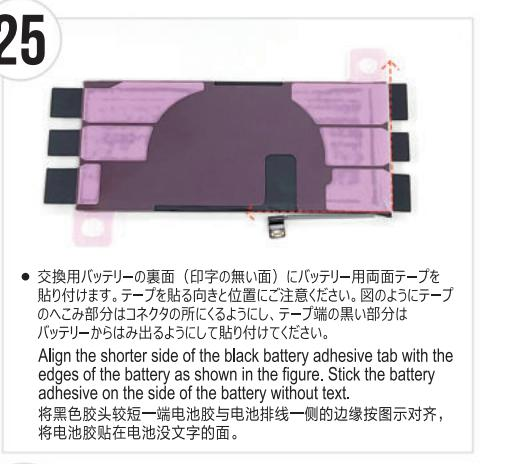
● 交換用バッテリーの裏面（印字の無い面）にバッテリー用両面テープを貼り付けます。テープを貼る方向にご注意ください。図のようにテープのへこみ部分はコクタの所にあるようにし、テープ端の黒い部分はバッテリーからみ出るようにして貼り付けてください。
