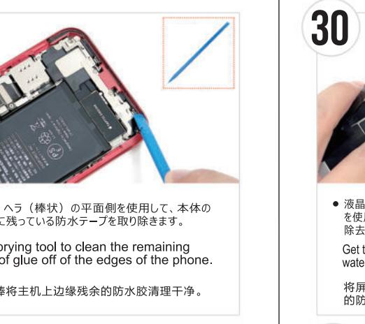
● 図のように、ヘラ（棒状）の平面側を使用して、本体のフレーム端に残っている防水テープを取り除きます。
