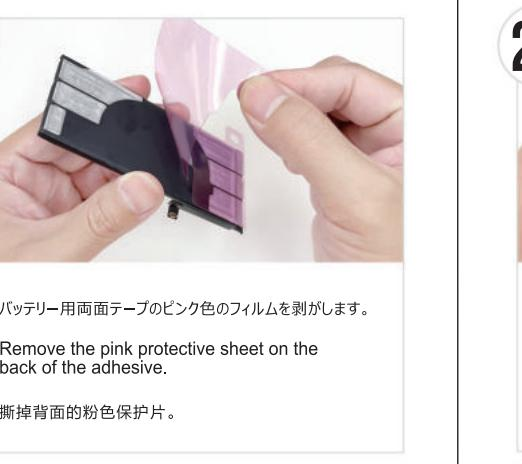
● バッテリー用両面テープのピンク色のフィルムを剥がします。
