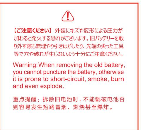
**【ご注意ください】** 外装にキズや変形による圧力が加わると発火する恐れがございます。旧バッテリーを取り外す際は無理やり引きはがしたり、先端の尖った工具等で穴や破れが生じないよう十分にご注意ください。
