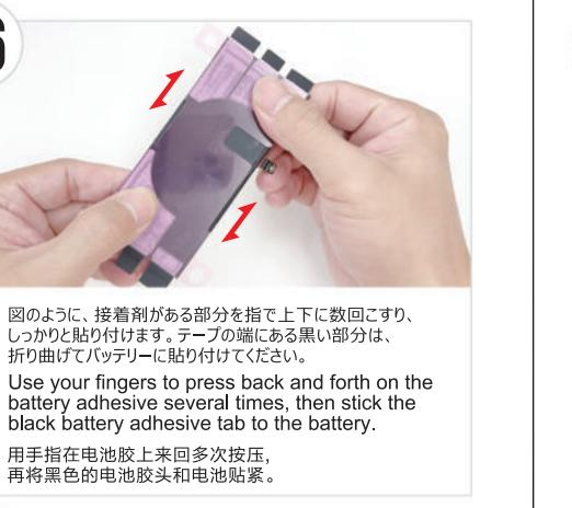
● 図のように、接着剤がある部分を指で上下に数回こすり、しっかりと貼り付けてます。テープの端にある黒い部分は、折り曲げてバッテリーに貼り付けてください。
