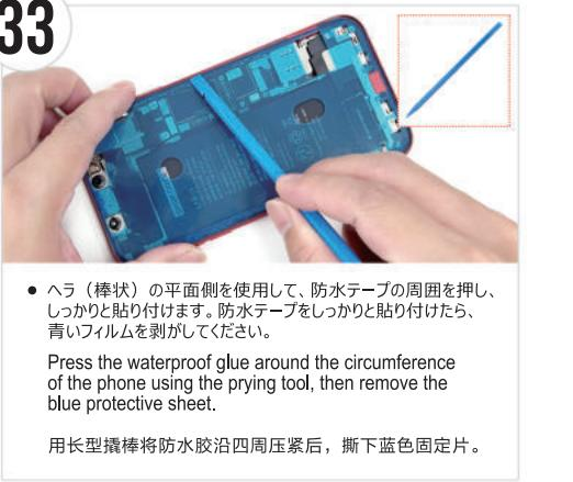
● ヘラ（棒状）の平面側を使用して、防水テープの周囲を押し、しっかりと貼り付けます。防水テープをしっかりと貼り付けたら、青いフィルムを剥がしてください。
