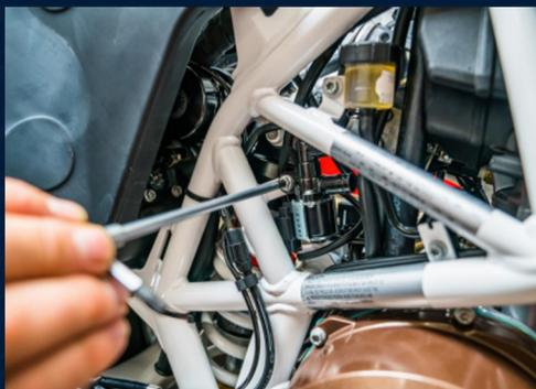
7º Desmontar electroválvula SAS, desenchufar conector y poner el dongle del kit para evitar fallo motor.
