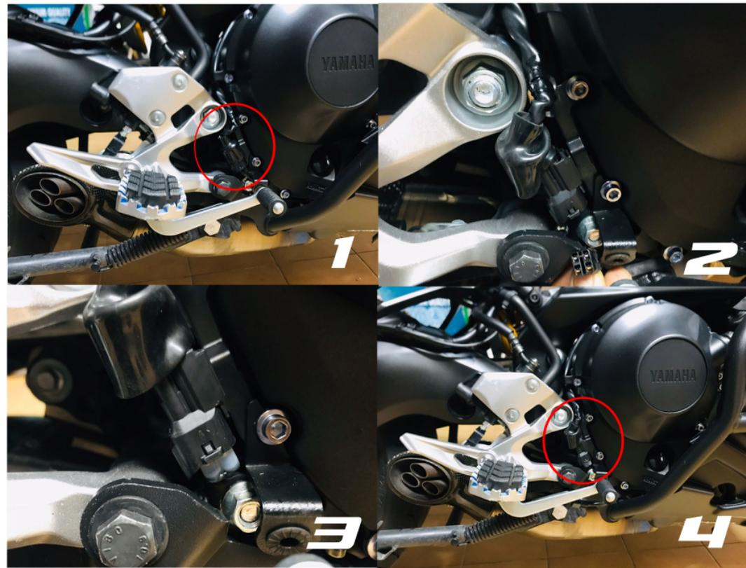
**1° Localizar el conector en la parte derecha de la moto, a la altura del freno trasero.**
