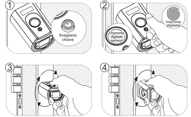
La manopola può essere ruotata liberamente di 360 gradi dopo essere stata bloccata. Per proteggere la serratura non essere danneggiato da torsione con forza.
