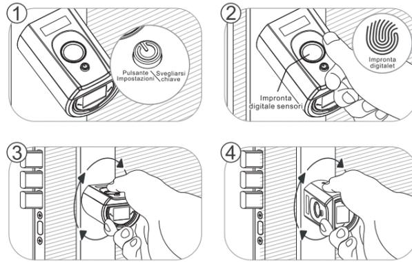
La manopola può essere ruotata liberamente di 360 gradi dopo essere stata bloccata. Per proteggere la serratura non essere danneggiato da torsione con forza.
