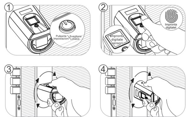
La manopola può essere ruotata liberamente di 360 gradi dopo essere stata sbloccata. Per proteggere la serratura non essere danneggiato da torsione con forza.
