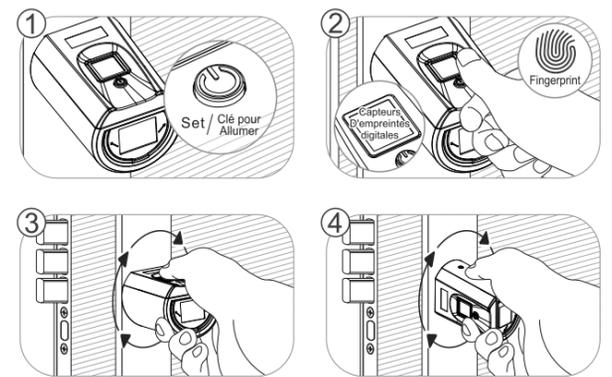
Le bouton peut être tourné à 360 degrés librement après avoir été verrouillé. Pour protéger la serrure ne pas être endommagée par la torsion avec force.
