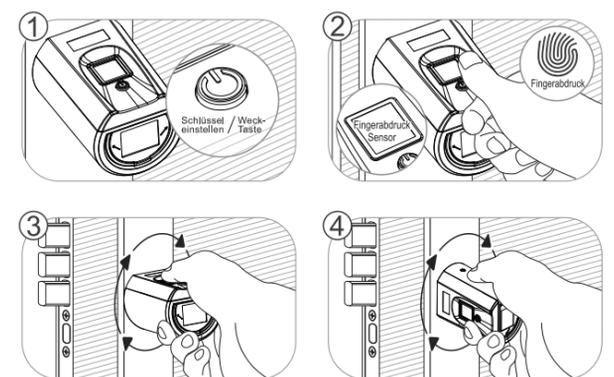
Der Knopf kann sich nach dem Verriegeln um 360 Grad frei drehen. Schützen Sie das Schloss, damit es nicht durch Torsionskräfte beschädigt wird.
