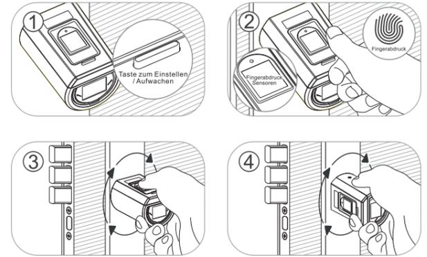
Der Knopf ist nach dem Abschießen frei drehbar, um das Schloss vor einer Beschädigung durch gewaltsames Verdrehen zu schützen.
