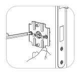
5.Installare il montaggio staffa e stringere il viti della staffa di montaggio
