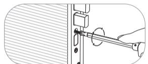
4. Instalación Tornillos de fijación
