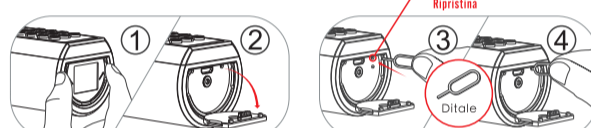
1. Aprire il coperchio in silicone 2. Trovare il ditale negli accessori allegati 3. Trovare il foro dove si trova il pulsante di reset 4. Inserire il ditale nel foro e premere il pulsante di reset
