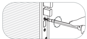
4. Instalación Tornillos de fijación
