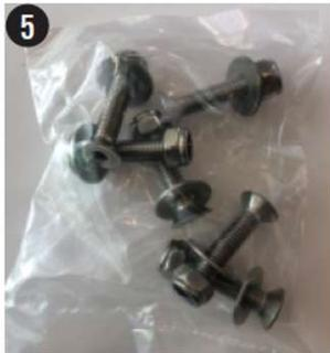
5. 写真のとおり長ボルトとそれに対応したロックナットを準備します。ホイールベースと下部フレームの穴を上から下に向かって長ボルトを差し込み、ワッシャーとロックナットを下からはめて固定します。
