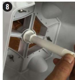
8. 六角付パイプをオス側コネクタにねじ込み接続し、タンクカバーと1番目の六角モジュールを固定します。
