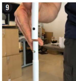
9. 両側オスロッドの6本を先ほど取り付けた両側メスロッドの上から差し込みます。同様にピン穴の位置を合わせてください。
