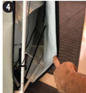
4.下部フレームの下にグローテントのフラップがあるので内側に収まるように調整します。
