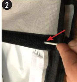
2.マジックテープ部分の強度を増す目的でファイバークラスロッドを挿入します。
