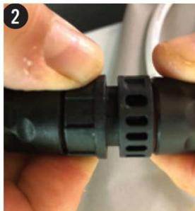
2. 白いT字コネクタの末端のコネクタをLED電源装置の出力側のコネクタと接続します。ロックリングを回してコネクタを固定します。
