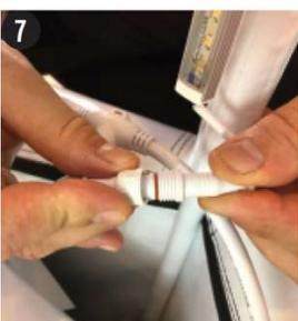
3. コネクタを接続後にロックリングをねじ込み固定します。
