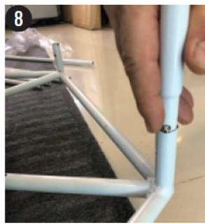
8. 両側メスロッドの6本を支柱にはめていきます。挿入したロッドとピン穴の位置があうようにします。6つのコーナー全てについてロックピンが穴に合っていることを確認してください。
