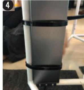
4. 固定位置が決まった後に結束バンドを締め付けて固定します。
