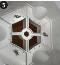
5. 蝶ネジの貫通部を付属のナットで固定します。
