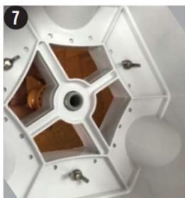
7. オス側コネクタの上端が六角モジュールに見えます。これに六角付パイプを接続していきます。
