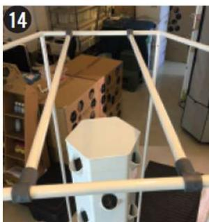
14. ファン固定用フレームのバーの幅を20cm程度になるようにプラスチック取付治具をスライドさせて調整してください。これでフレームは完成です。
