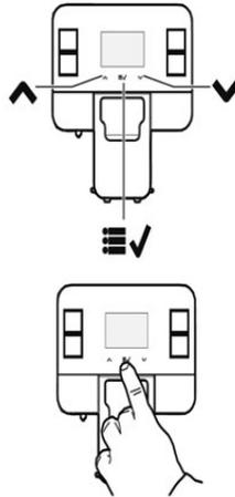
5. En el display la maquina nos indicara que realizara un enjuague del circuito para purgar la maquina. Colocaremos un recipiente debajo de las salidas del erogador y pulsaremos el ok. Durante unos 90 seg. erogara agua por las salidas. Cuando finalice este proceso , retiraremos el recipiente y la maquina entrara en proceso de calentamiento, cuando acabe este proceso estará lista para el uso.
