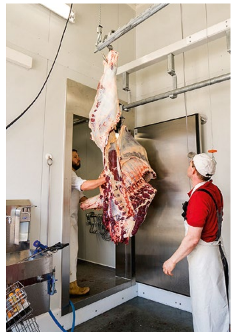
Über die Rohrbahnanlage werden die Rinderviertel direkt in die Kühlung geschoben. Vom Kugelschuss bis hierher hat es gut eine Stunde gedauert.
