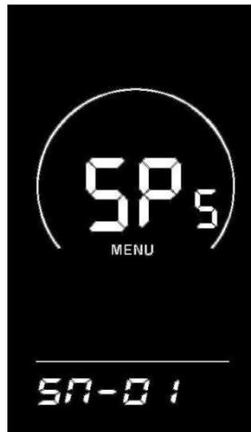
Auswahlschnittstelle für Geschwindigkeitssensormagneten
