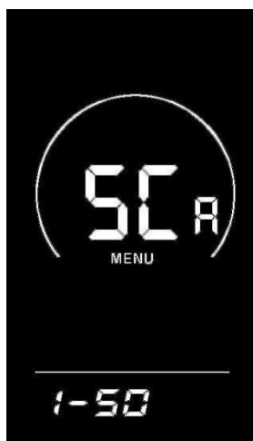
L'interface de réglage de la valeur d'assistance proportionnelle
