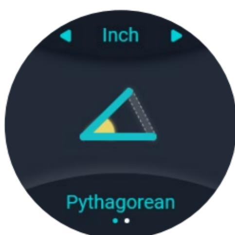
1. Misura Pitagorica - Misura il lato A, il lato B e l'angolo ab. La lunghezza del terzo lato viene calcolata automaticamente.
