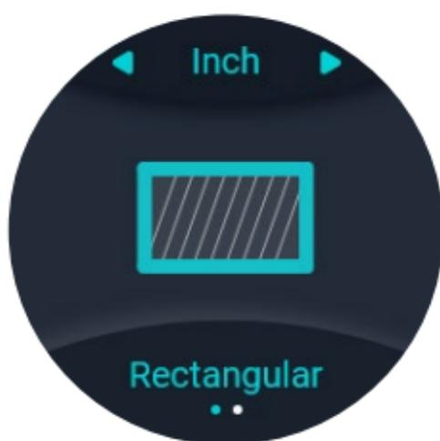
2. Misura dell'area rettangolare - Misura la lunghezza A e la larghezza B. L'area viene calcolata automaticamente.
