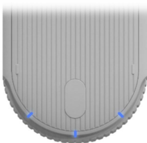
Quando la ruota viene utilizzata per la misurazione, i punti di riferimento in basso si illuminano. L'utente può selezionare i punti iniziali/finali da utilizzare come riferimento selezionando la posizione in cui viene abitualmente tenuta.
