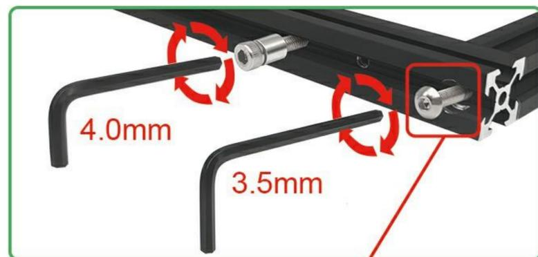
Achten Sie auf die Richtung der Y-Achse, die Gewindenut ist nach außen gerichtet.
