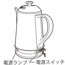
⑤沸騰すると自動的に電源スイッチが「OFF(上)」になって電源ランプが消灯します。
