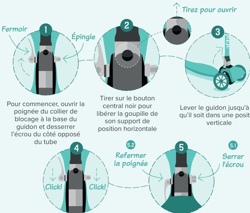
Pour commencer, ouvrir la poignée du collier de blocage à la base du guidon et desserrer l'écrou du côté opposé du tube
