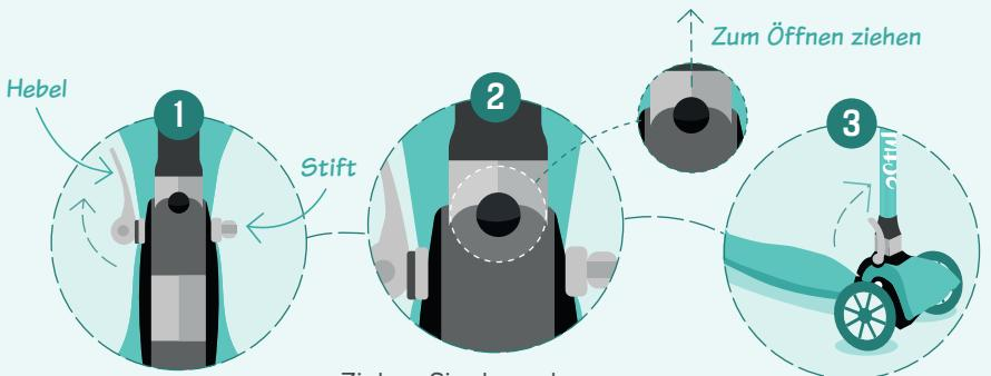
Öffnen Sie zunächst den Hebel und lockern Sie den Stift nach Bedarf.
