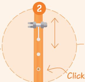
Faites glisser le guidon à la hauteur désirée, assurez-vous que le bouton de verrouillage se mettent bien en place
