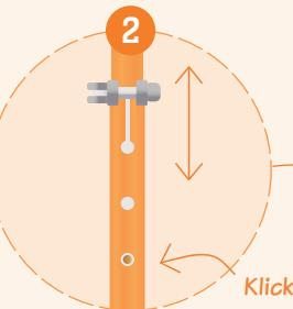
Schieben Sie den Lenker auf die gewünschte Höhe und achten Sie darauf, dass der Drucktaster einrastet.
