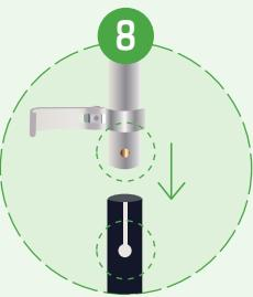
Vuelva a colocar el vástago de manillar en la parte superior del vástago principal, teniendo cuidado de alinear el botón de sujeción con los orificios del lado del vástago
