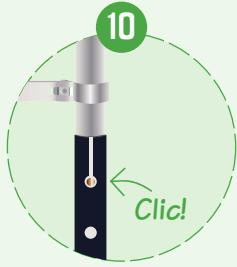
Una volta in posizione corretta, il pulsante deve fuoriuscire dal primo foro (se necessario, far ruotare il tubo fino a trovare la posizione corretta
