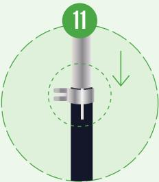
Du côté opposé au bouton de maintien, alignez le collier de serrage avec la rainure de la tige principale et poussez
