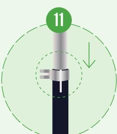
Sul lato opposto al pulsante di bloccaggio, allineare il morsetto a collare con l'incavo presente sul piantone e spingerlo in posizione
