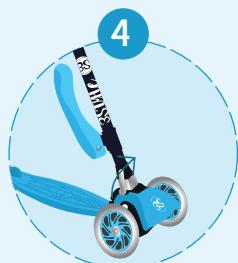
Dadurch wird der Verriegelungsmechanismus aus seiner Haltemulde gelöst, sodass Sie die Griffe nach oben ziehen können
