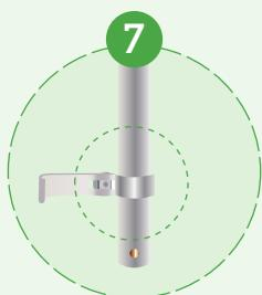
Posizionare il morsetto a collare sul tubo del manubrio sopra al pulsante di bloccaggio
