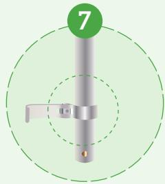
Vuelva a colocar la abrazadera de ajuste en el vástago del manillar, por encima del botón de sujeción
