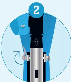
Abra el mecanismo de bloqueo del manillar girando la palanca hacia arriba
