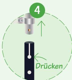
Während Sie die Griffe festhalten, drücken Sie den Halteknopf ganz hinein. Heben Sie an, um die Griffe und die Klemme vom Hauptvorbau zu entfernen
