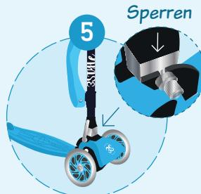
Heben Sie die Roller-Griffe in die obere Position. Der Roller-Verriegelungsmechanismus fällt in seinen Verriegelungsmechanismus
