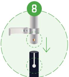
Setzen Sie den Griffstiel wieder in die Oberseite des Hauptvorbaus ein und achten Sie darauf, dass der Griffknopf mit den Löchern an der Seite des Vorbaus ausgerichtet ist
