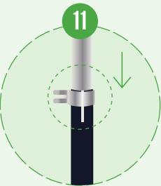
En el lado opuesto al botón de sujeción, alinee la abrazadera de ajuste con la ranura del vástago principal y empújela a su sitio
