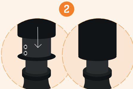
Posizionare il sellino in modo che l'incavo guida consenta di metterlo in posizione corretta sull'anello di sostegno
