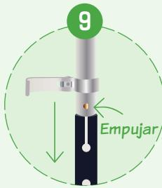
Presione el botón de sujeción y empuje el vástago del manillar hacia abajo
