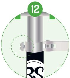
Setzen Sie die Schraube wieder ein und ziehen Sie sie fest, um die Kragenklemme wieder zu sichern.
