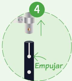
Sujetando el manillar, presione a fondo el botón de sujeción. Levante para extraer todo el manillar y la abrazadera
