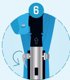
Chiudere il meccanismo di blocco del manubrio abbassando la levetta
