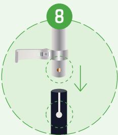
Posizionare il tubo del manubrio sulla parte superiore del piantone facendo attenzione ad allineare il pulsante di bloccaggio coi fori situati lateralmente sul tubo
