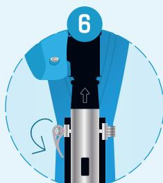
Cierre el mecanismo de bloqueo del manillar bajando la palanca
