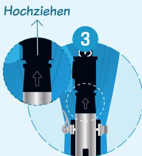
Ziehen Sie die Roller-Freigabepumpe nach oben und halten Sie sie in der offenen Position
