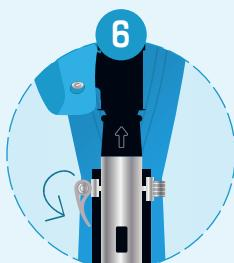
Schließen Sie die Griffverriegelung, indem Sie den Hebel nach unten klappen
