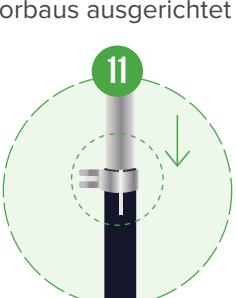
Richten Sie auf der dem Halteknopf gegenüberliegenden Seite die Klemmringklemme mit der Nut der Hauptvorbauvertiefung aus und drücken Sie sie in Position
