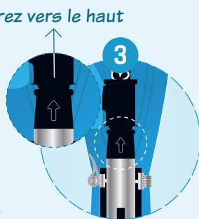
Tirez sur la soupape de desserrage de la trottinette et maintenez-la en position ouverte
