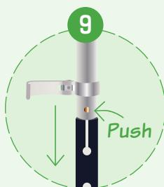
Premere il pulsante di bloccaggio e inserire il tubo del manubrio all'interno del piantone
