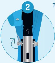
Ouvrez le mécanisme de verrouillage du guidon en soulevant le levier
