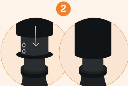
Coloque el asiento de forma que la muesca guía le permita caer correctamente en su posición en la parte superior del anillo de sujeción
