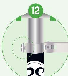
Vuelva a colocar el tornillo y apriételo para asegurar la abrazadera de ajuste una vez más. ¡Listos!
