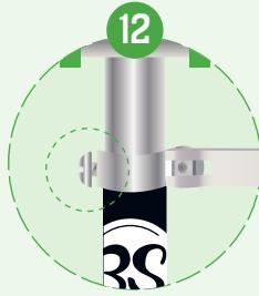
Riposizionare la vite e stringerla per fissare di nuovo il morsetto a collare. Siamo pronti a partire!
