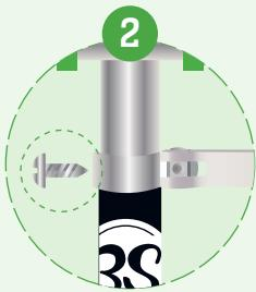
Verwenden Sie das mitgelieferte Werkzeug, um die Halteschraube der Kragenklemme zu entfernen
