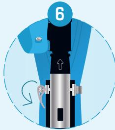
Fermez le mécanisme de verrouillage du guidon en tournant le levier vers le bas
