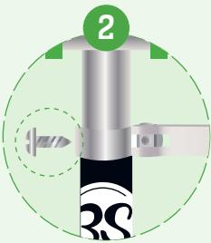
Utilice la herramienta suministrada para retirar el tornillo de sujeción de la abrazadera
