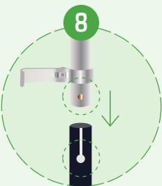
Insérez de nouveau la tige de la poignée au sommet de la tige principale, en prenant soin d'aligner le bouton de maintien avec les trous sur le côté de la tige
