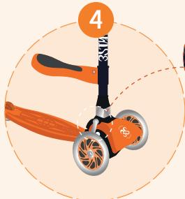
Fermez le mécanisme de verrouillage de la trottinette
