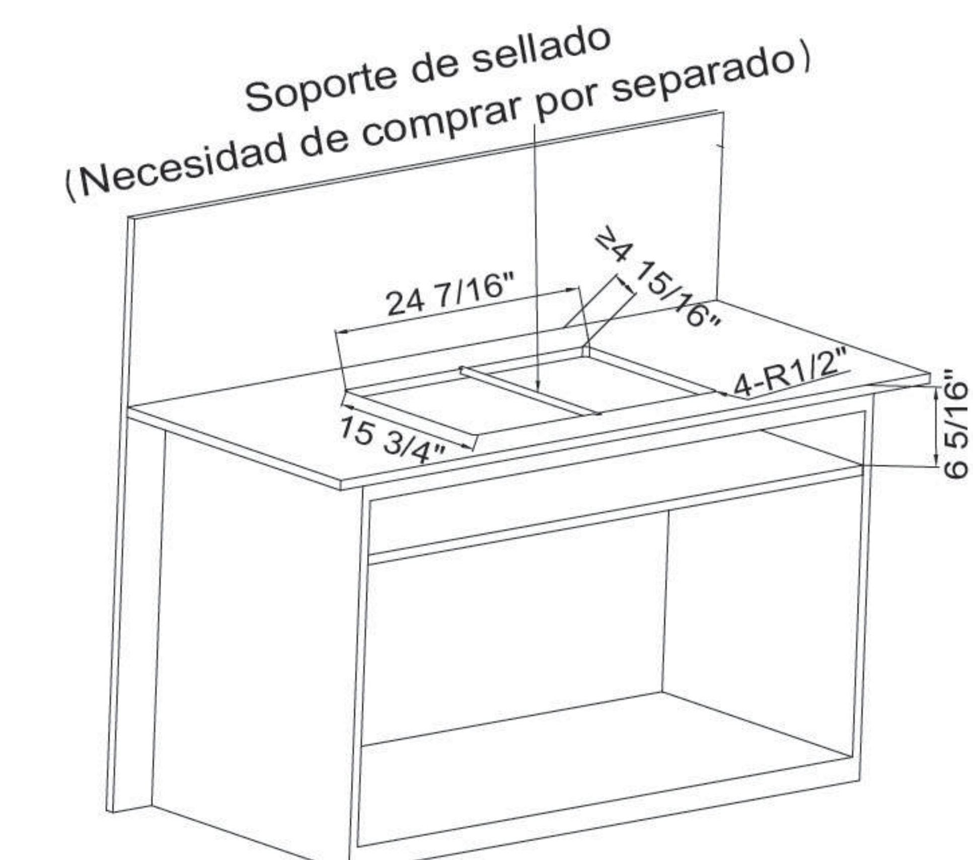
Instalación de dos equipos
