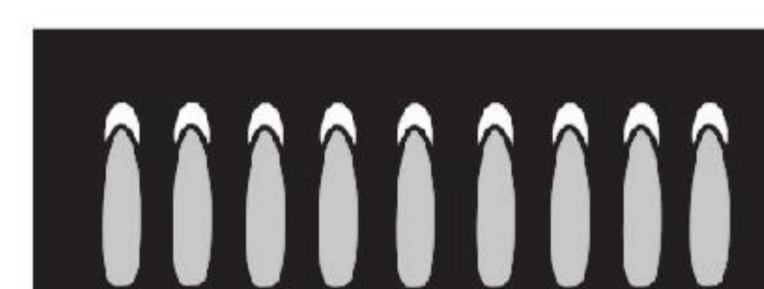
(B) Puntas amarillas en conos exteriores— Normal para gas propano
