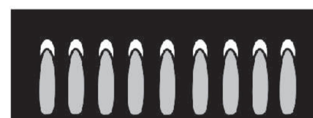
(B) 火焰外锥上有黄色火焰尖端—丙烷气正常
