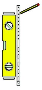
Realizar los taladros en la pared, así como insertar los tacos adecuados según pared y atornillar las barras de sujeción verticales
