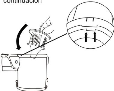
8) Vuelva a ensamblar el Recipiente para el Polvo como se muestra en la siguiente ilustración
