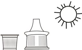
6) Según la ilustración 6, instale el filtro HEPA y la carcasa juntos
