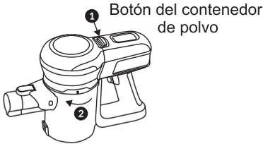
2) Según la 2ª ilustración, gire las partes superior e inferior en direcciones opuestas al contenedor de polvo abierto
