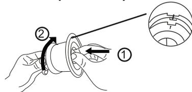
7) Vuelva a instalar el filtro HEPA lavado y completamente seco (o nuevo) en el contenedor de polvo como se ilustra a continuación
