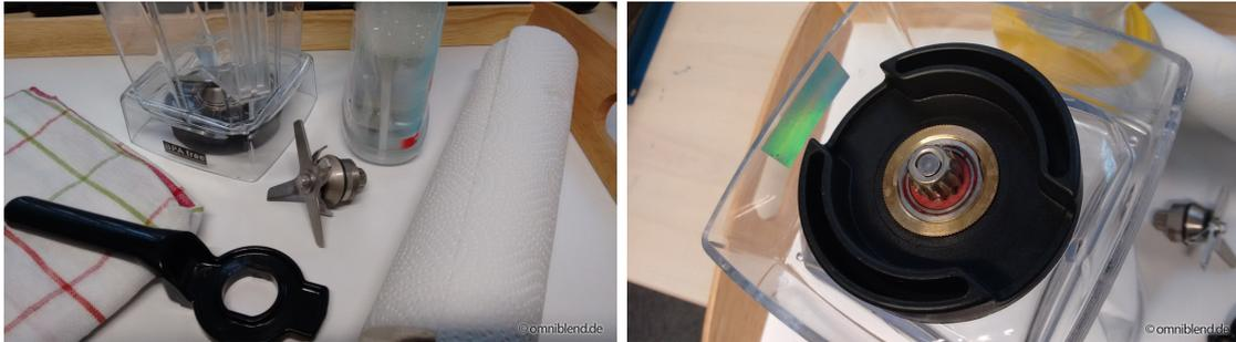
Drehen Sie den Behälter um und setzen Sie das Werkzeug in den schwarzen Ring, der das Messer von unten fixiert. Lösen Sie den Ring, indem Sie das Werkzeug gegen den Uhrzeigersinn drehen. Legen Sie ein gefaltetes Küchentuch oder eine Zeitung unter die offene Seite des Behälters, bevor Sie den schwarzen Ring von Hand ganz lösen und abnehmen. Manchmal fällt das Messer von allein aus dem Behälter.
