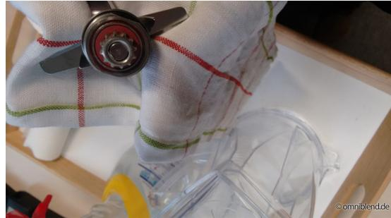
Greifen Sie das neue Messer mit einem Tuch (Achtung! Die Klingen des neuen Messers sind noch schärfer als die des alten!) und drücken Sie es von innen in den Behälter, so dass es fest am Boden des Behälters anliegt:
