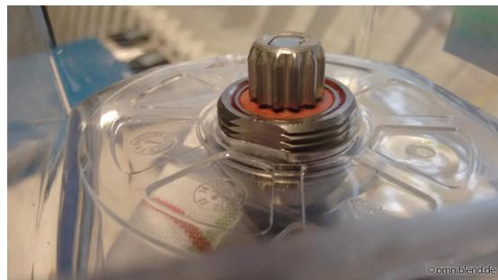
Setzen Sie nun den schwarzen Ring von außen auf und drehen Sie ihn mit der Hand fest, so dass das Messer nicht mehr herausfallen kann. Dann setzen Sie das Werkzeug noch einmal auf und ziehen den schwarzen Ring im Uhrzeigersinn fest an.
