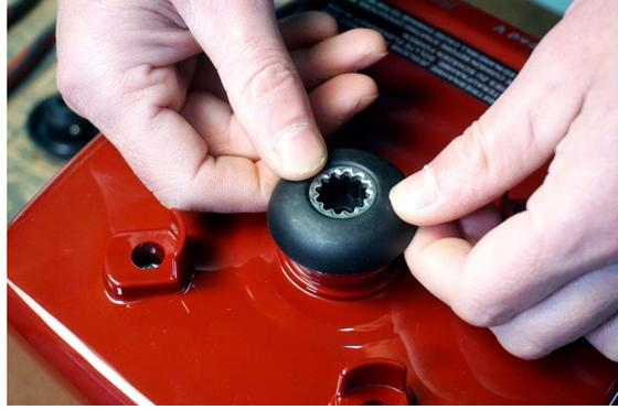
Drehen Sie die Antriebswelle dann wieder so, dass die Öffnung für die Schraube sichtbar ist und setzen Sie die Schraube mit Hilfe des Schraubenziehers oder einer Pinzette ein. Schrauben Sie sie fest.
