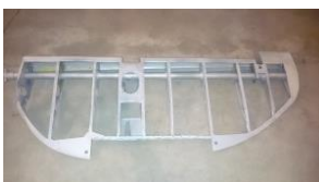
Texan T-6 Elevator (sandgestrahlt)
