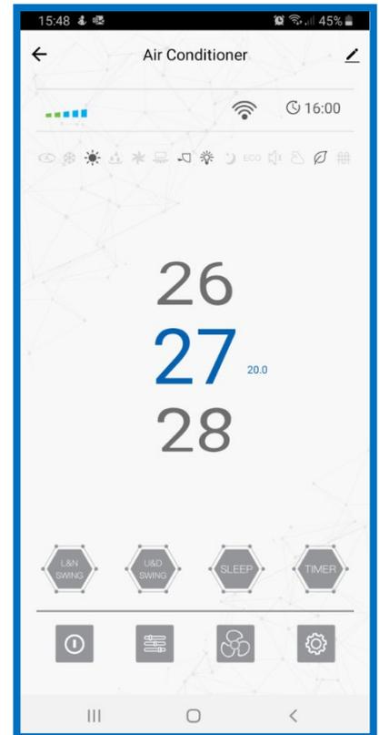
**NOTE : POUR PASSER DU MODE CHAUD AU FROID, UNE TRANSITION DE 1 à 5 MINUTES EST NECESSAIRE POUR LA MISE EN ROUTE DU COMPRESSEUR.**
