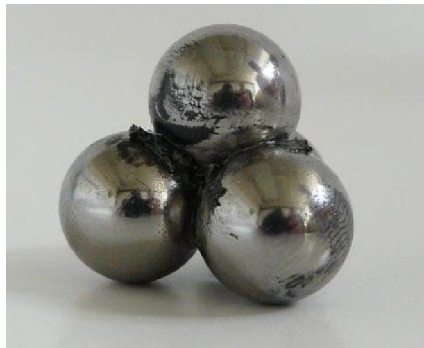
Foto: Mit Testschmierstoff bedecktes Vierkugelsystem(links); Verschweißte Kugeln nach Test(rechts)
