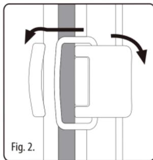
Un cadenas est installé entre les deux supports de verrouillage pour verrouiller solidement la caméra.
